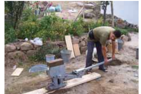
Şekil 5. (a) Geleneksel kerpiç tuğlanın yapımı. (b) El makina yardımıyla stabilize edilmiş kerpiç blokların yapımı.
