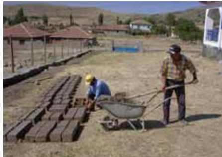
Şekil 5. (a) Geleneksel kerpiç tuğlanın yapımı. (b) El makina yardımıyla stabilize edilmiş kerpiç blokların yapımı.
